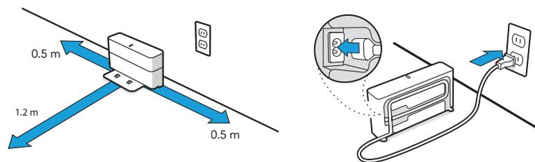
**AVERTISMENT:** Pentru a preveni riscul căderii pe scări a robotului dvs., asigurați-vă că stația de încărcare este amplasată la cel puțin 1,2 metri de la partea de sus a scărilor.
