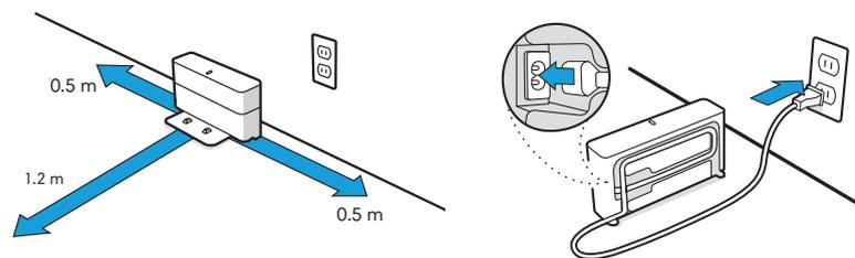
**VAROVÁNÍ:** Abyste zabránili riziku pádu robota ze schodů, ujistěte se, že se nabíjecí stanice nachází alespoň 1,2 metru od vrcholu schodů.
