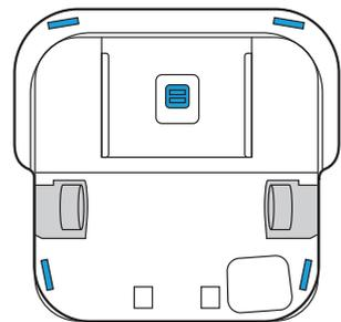
**Important:** Nu pulverizați soluția de curățare sau apă pe senzori sau pe deschiderile senzorilor.
