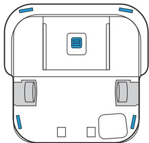
**Fontos:** Ne permetezzen vizet vagy tisztítószert az érzékelőkre, illetve az érzékelőnyílásokba.
