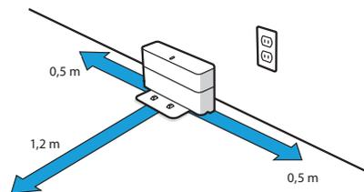
Включете захранващия кабел в зарядната станция и след това в стенния контакт.
