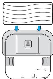
Odpojte stávající čisticí utěrku stisknutím tlačítka na přední straně robota.
