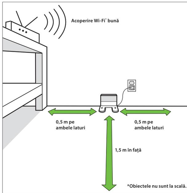
Plasați stația de încărcare pe o suprafață la nivelul podelei, rezemată de perete. Asigurați-vă că nu există obiecte și suprafețe reflectorizante pe o rază de 1,5 m de zona din față încărcătorului și 0,5 m de ambele părți ale stației de încărcare.
