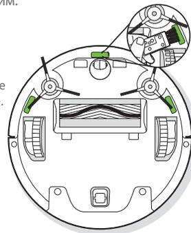
Избършете бронята с четката на многофункционалния инструмент за почистване.
