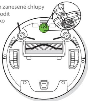
Kartáčem multifunkčního čistícího nástroje očistěte senzory proti pádu ze schodů, aby dobře fungovaly.
