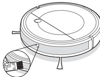
Suchým hadříkem otřete dobíjecí kontakty robota a nabíjecí stanice, aby dobře fungovaly.
