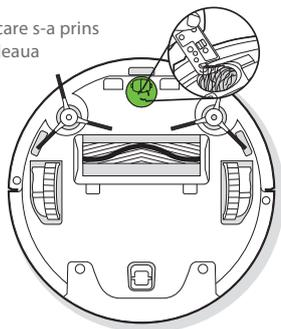
Ștergeți senzorii pentru detectarea înălțimii cu peria de pe instrumentul de curățare universal pentru a le păstra gardul de eficiență.
