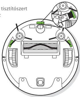
A hatékonyság megőrzése érdekében száraz ruhával törölje le a robotot és a töltőállomás töltőérintkezőit.
