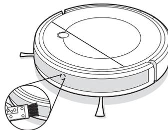
Ștergeți contactele de încărcare ale robotului și stației de încărcare cu o cârpă uscată pentru a le păstra gradul de eficiență.
