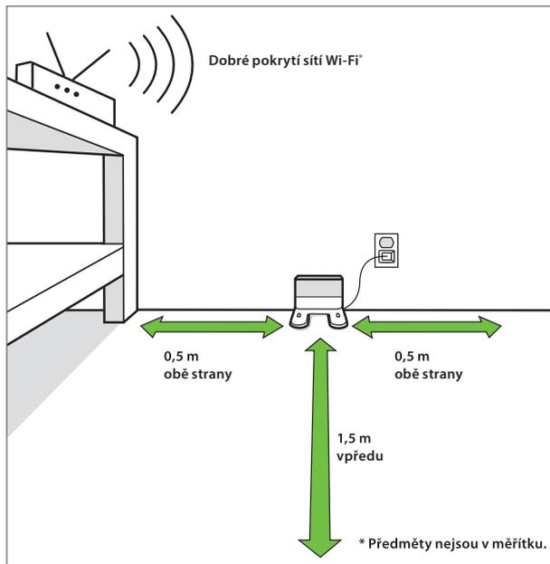
Umístěte nabíjecí stanici na rovnou podlahu ke zdi. Z bezprostředního okolí nabíjecí stanice (1,5 m před ní a 0,5 m na obou stranách) odstraňte předměty a reflexní povrchy.
