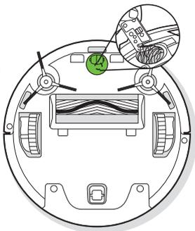
Избърсвайте сензорите срещу падане по стълби с четката на многофункционалния инструмент за почистване, за да поддържате ефективността им.
