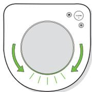
Amikor a robot érzékeli, hogy a portartályt ki kell üríteni, a fénygyűrűs kijelző pirosan világít a hátsó rész felé irányuló törlő mozdulatokkal.
