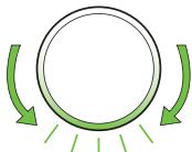
Amikor a robot érzékeli, hogy a portartályt ki kell üríteni, a fénygyűrűs visszajelző pirosan világít a hátsó rész felé irányuló animált mozgással.
