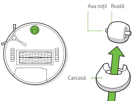
**Important:** Blocarea roții frontale cu fire de păr și reziduuri poate duce la deteriorarea podelei. Dacă roata nu se rotește liber după ce ati curătat-o, contactați Departamentul de relații cu clienții.
